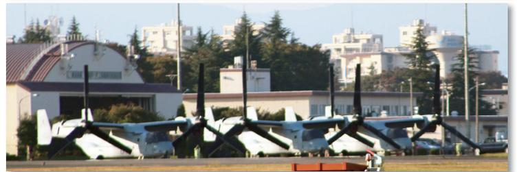
沖縄・普天間基地に配属されており、今年7月から毎月横田基地に飛来しているMV-22オスプレイ。全長約17.5m、全幅約25.5m、乗員4名、乗客24～32名、最大速度565km/h。MV-22は海兵隊仕様で兵員輸送が主任務だが、横田基地に来年配備を噂されるCV-22は空軍仕様のもので、特殊任務に使用される機種のため事故率はMVより数倍高い。
