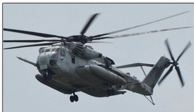
▲大型ヘリ CH53E。アフガンでの事故率は、第 1 位が MV-22 オスプレイ、…第 3 位が CH-53E となっている。全長約 30 m、主回転翼直径約 24 m、315km/h の高速性能を持つ。
