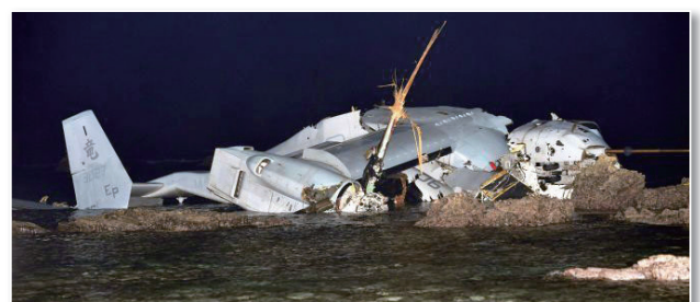
▲ 12月14日琉球新報より転用した写真。右翼の先のローター部分が固定翼モード。プロペラは見る影もなく、胴体と右翼がつながっているが、そのほかはバラバラになってしまった。意外と弱い機体だ。
