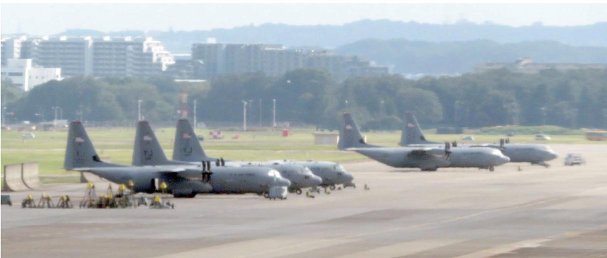
↑旧型C-130Hに代わるC-130J（胴体が約5m長くなり、羽が6枚になった）。常駐していたC-130H・14機は、10月16日に最後の2機が横田基地を後にした。現在基地周辺で旋回訓練を行っているのはC-130Jである。
